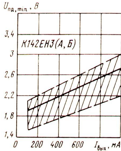
Зависимость минимального падения напряжения на стабилизаторах от выходного тока. Заштрихована область разброса значений параметров для 95% микросхем. Сплошной линией обозначена типовая зависимость
